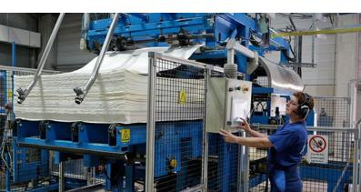
Zur Herstellung eines transportfähigen Produktes wird der Zellstoff schließlich entwässert und zu Ballen verschnürt. In dieser Form wird er an die weiterverarbeitenden Papierfabriken geliefert.
